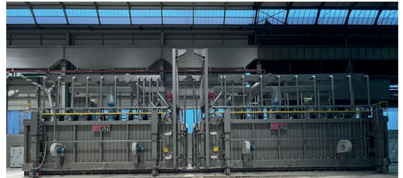
Ne è un esempio il nuovo forno di trattamento termico a gas, progettato con tecnologie a basso impatto ambientale. L’impianto consente un controllo accurato e un’ottimizzazione dei consumi energetici, contribuendo in modo significativo alla riduzione delle emissioni e al miglioramento dell’efficienza del processo produttivo.
